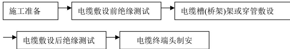
(2) 根据整个建筑的楼层结构，电缆敷设按房建施工进度采取分楼层、分阶段施工的方法进行。
